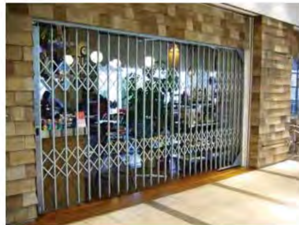
W5,000×H3,500 スチール製、片引き(回転扉)仕様、亜鉛メッキ仕様 下レールなし
