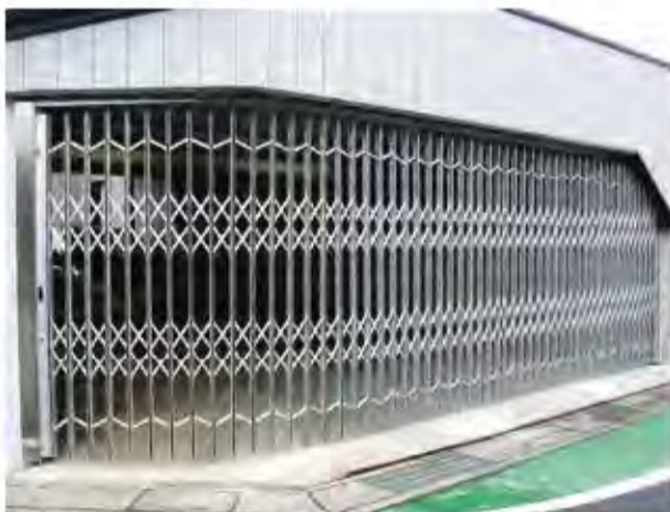
W8,200×H2,300 アルミ製(シルバー) 片引き仕様 フリー型、曲げR=900、下レールなし
