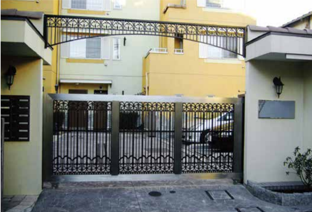
W4,000×H1,500 ステンレス製、片引き仕様、デザイン鋳物パネル仕様
