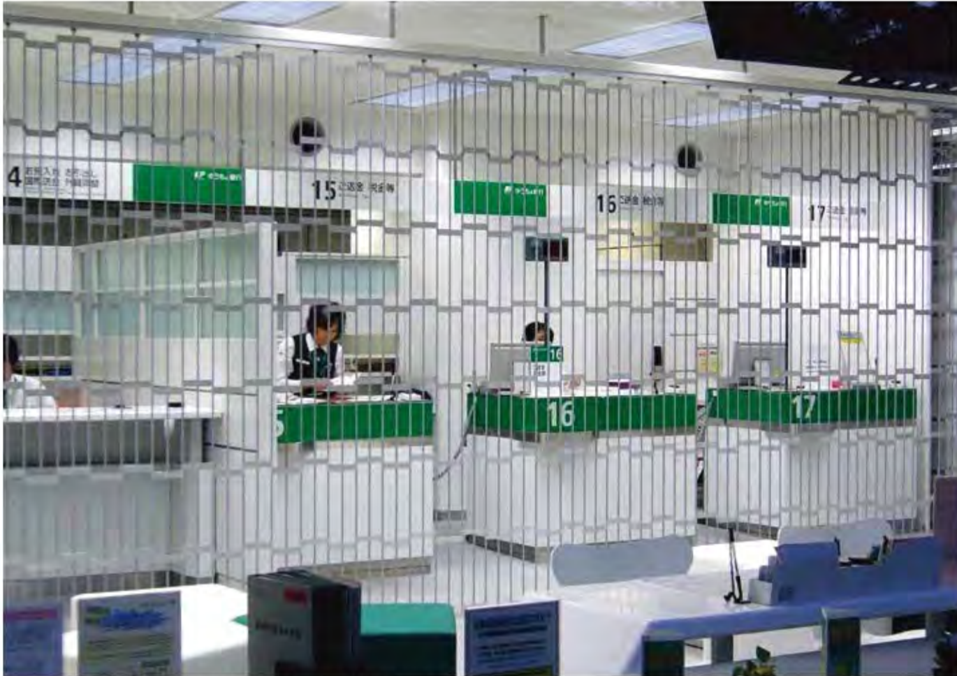
W12,000×H2,600 強化PC製パイプ、片引き仕様、下レールなし
