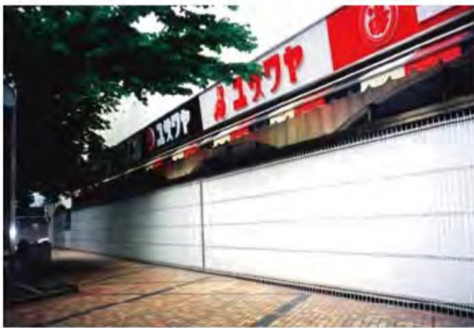
W26,000×H2,300 ステンレス製、両引き・角めし合わせ仕様、BOX型 ストレートタイプ、パンチングパネル入り
